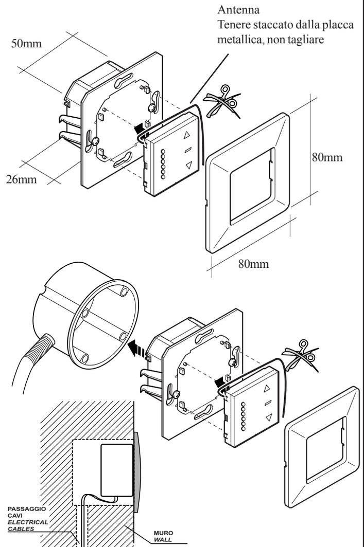
**L'apparecchio deve essere installato attraverso le viti di fissaggio o tramite i ganci laterali. Sguainare il meno possibile i conduttori e vincolarli con fascette in prossimità dei morsetti. Fissare i conduttori in modo che non possano uscire dalle loro sedi.**
