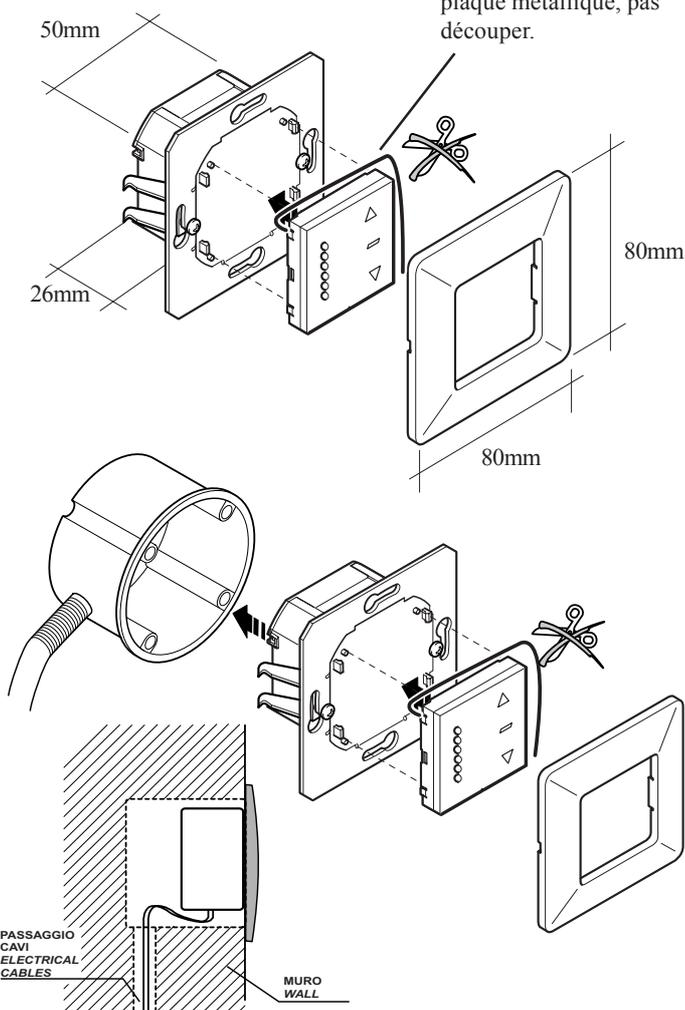
L'appareil doit être installé au moyen des vis de fixation ou des crochets latéraux. Dénuder le moins possible les conducteurs et les fixer avec des colliers autobloquants à proximité des bornes. Veiller à les fixer de manière à ce qu'ils restent bien à leur place.
