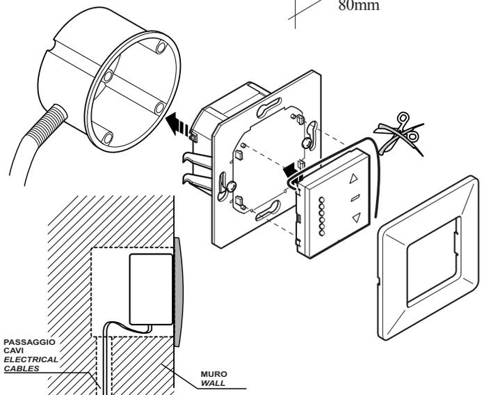
Das Gerät muss entweder mit den seitlichen Haken oder mit Befestigungsschrauben montiert werden. Halten Sie die abisolierten Teile so kurz wie möglich und befestigen Sie sie in der Nähe der Klemmen zusätzlich. Befestigen Sie die Kabel gut so dass sie nicht aus den Klemmen gezogen werden können.
